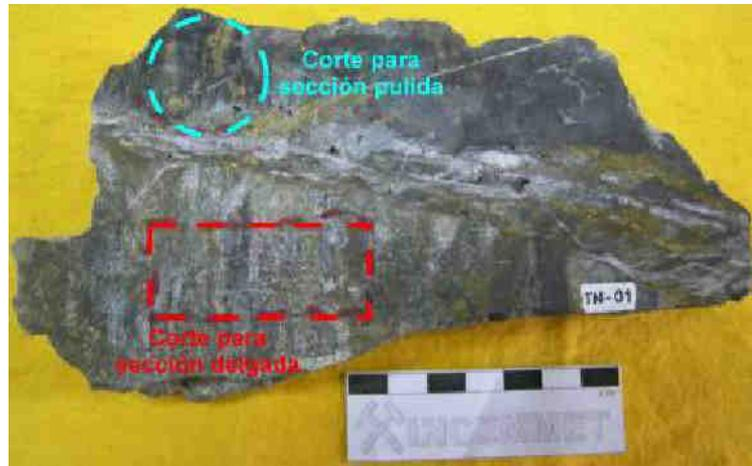
Foto. 2. Muestra de mano que donde el corte de sección delgada se hace en zonas que resaltan las características de la roca y el corte de sección pulida se hace donde se pueda apreciar las características de la mineralización
