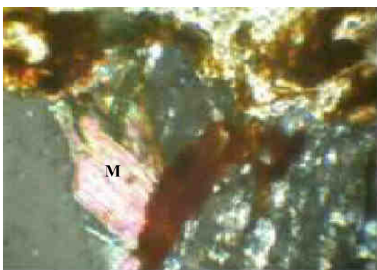
Fotomicrografía 1. Metaautunita (M), entre limonita, arcillas y plagioclasa. Toma con microscopía de luz transmitida a nicols cruzados. Aumento, 125X.
