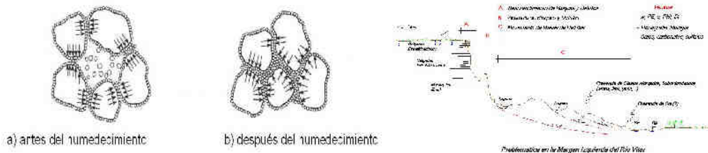
Figura 1 - Características de formación del Suelo Colapsible (modificado – Dudley, 1970) y fenomenología del colapso en el valle de Vitor
