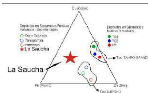
Diagrama 2.- Diagrama Ternario de las Composiciones Metálicas de los Depósitos VMS Conocidos de la Cuenca Lancones
