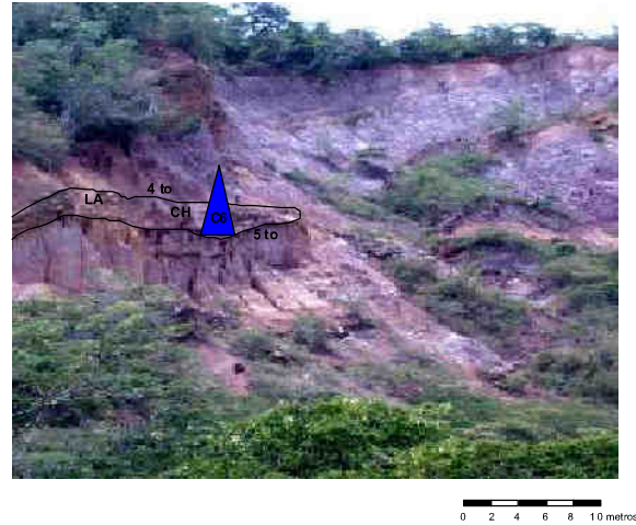
Figura 3. Canal principal grano decreciente con su respectiva acreción lateral y grandes espesores de llanura aluvial. Sección tipo, Formación Isnotú.
