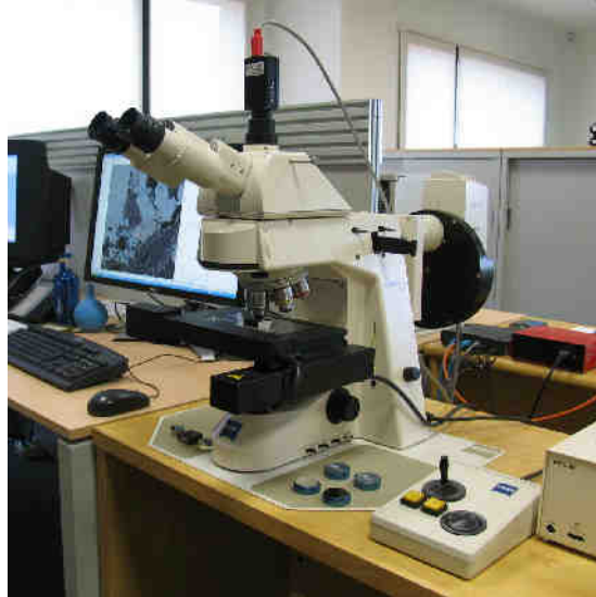
Figura 1 - Aspecto del sistema de análisis de menas metálicas basado en un microscopio Zeiss. En la parte trasera se pueden ver la fuente luminosa y las ruedas de filtros, y en lo alto la cámara.
