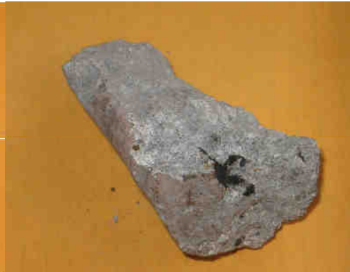
Fig. 3- Aspecto natural con inclusiones de óxido de hierro
