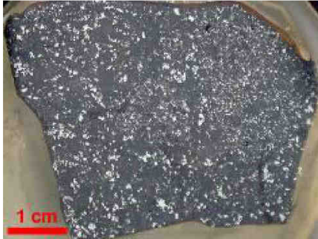
Foto. 2. Muestra pulida del meteorito donde se observa los diseminados de minerales metálicos.
