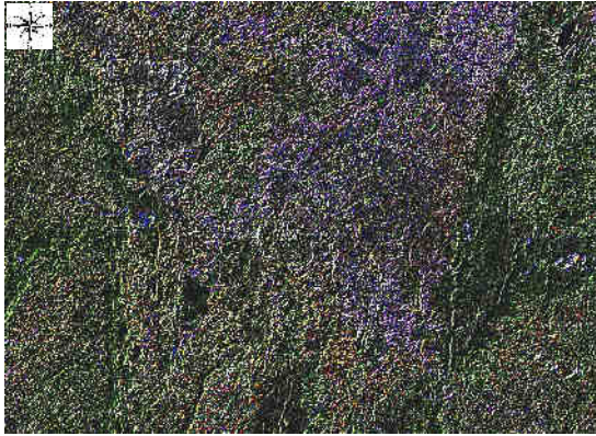
Figura 4. Detalle de la imagen aplicando la convolución 3x3 Right diagonal edge detection. 7-5-1 (RGB). Se observan dos rangos predominantes NNE y SW.
