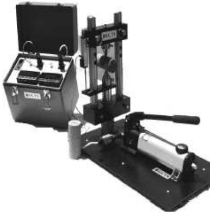
Figura 2. Equipo de ensayo de carga puntual en roca.
