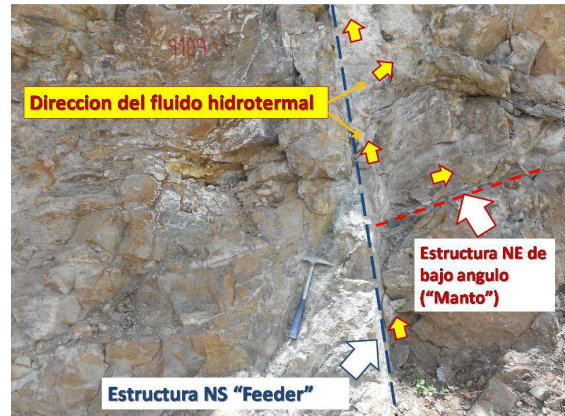
Fotografía N°6. Estructura nortesur (NS) cortando y mineralizando estructuras noreste (NE), las cuales forman pequeños mantos (<20 metros).
