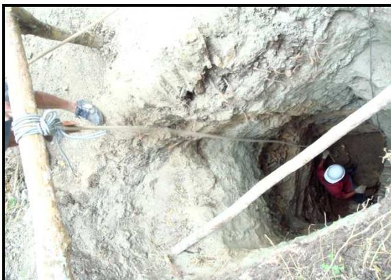
**Foto Nº 8:** Sector Roca Rajada - Pique de desarrollo con sección de 1.5 x 1.5 m. con una profundidad de 10 m. Roca caja fuertemente alterado <sup>(2)</sup>.
