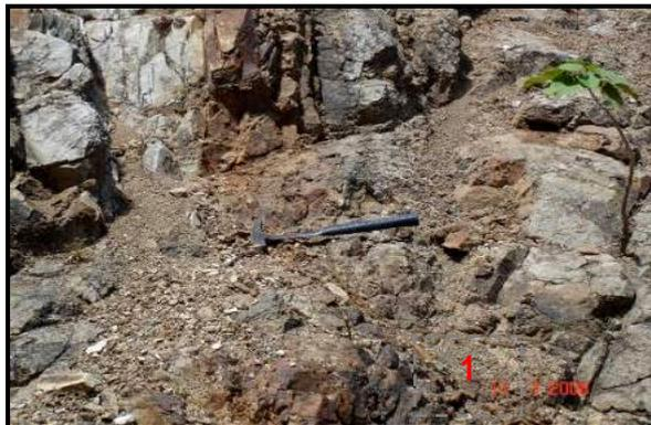
**Foto N° 2:** Sector Jambur - Estructuras mineralizadas, vetas de cuarzo-oro-óxidos con dirección NE-SO, hospedadas en secuencias volcánicas.
