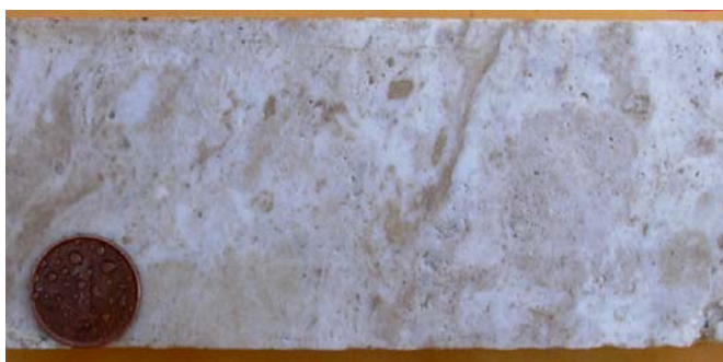
Foto N° 1.- IQD-145 43m. Sílice "vuggy" blanco de baja densidad 53ppb Au, 74 ppm As, 0.04 ppm Hg
