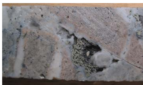
Foto N° 5.- Brecha silice calcedónico + sulfuros (Mbx): IQD 105 (230.5m) 5.3 gr/t Au
