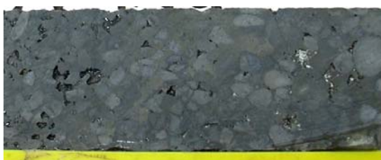
Foto N° 4.- Brecha de Silice vuggy + silice masivo + sulfuros (Rbx): IQD 134 (230.5m) 15.3 gr/t Au
