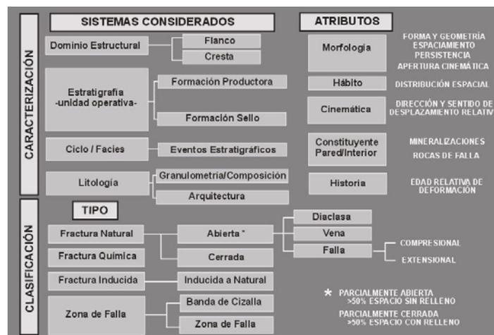
**Figura 1. Aspectos considerados en la clasificación y caracterización de atributos de macrofracturas aplicable a intervalos corazonados y afloramientos. GIGA 2004.**
