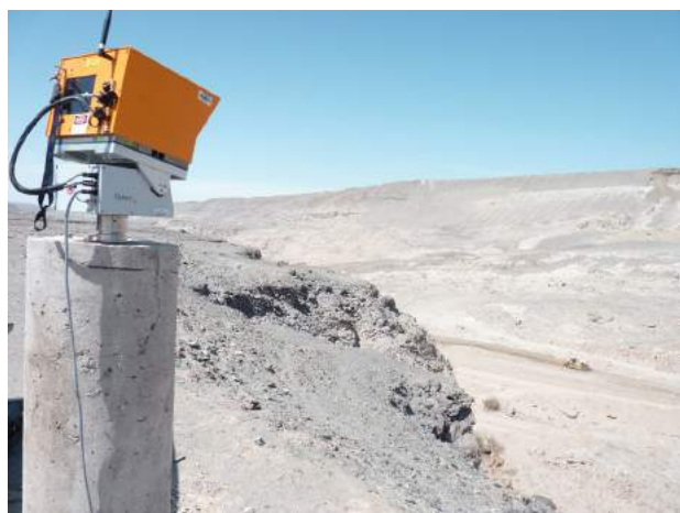
Figura 6. Vista del Escáner de monitoreo LiDAR en el flanco izquierdo del valle de Sigwas.
