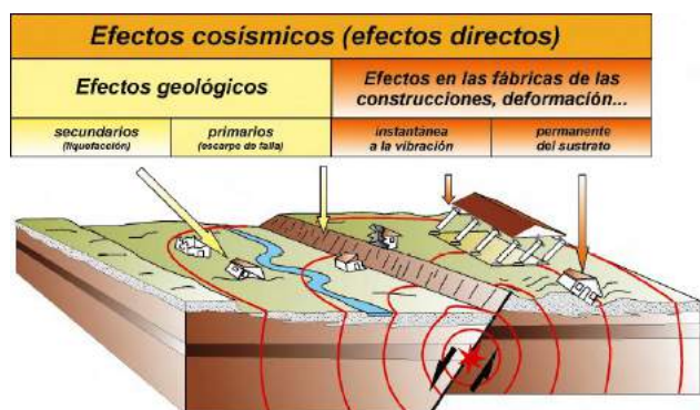
Figura 7. Diagrama de distribución de efectos cosísmicos (efectos directos). (Tomado de Rodríguez-Pascua et al., 2011)
