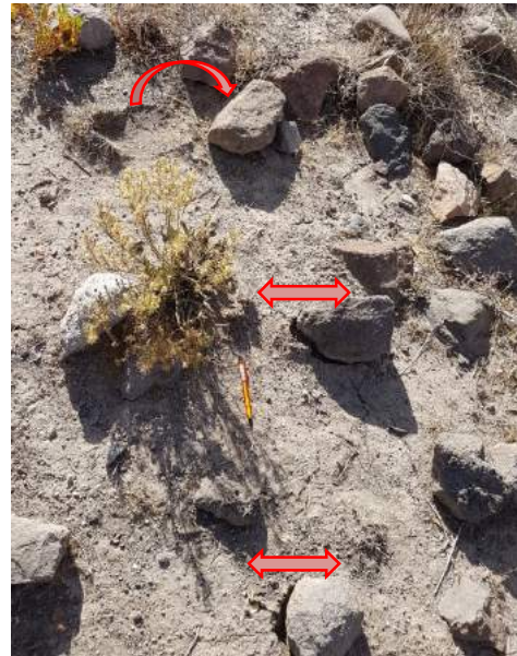
Foto 4. Se observa bloques movidos, en algunos casos volteados, por la vibración del terreno frente a las ondas sísmicas.
