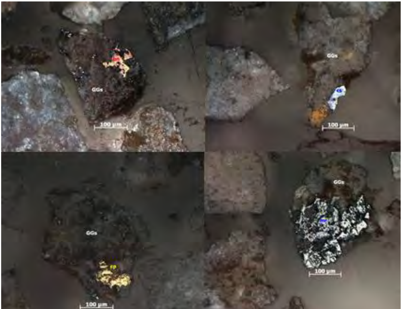
Figura 2. Arriba: Bornita (bn) ocluida en ganga; calcosina (cc) asociado a ganga. Abajo: calcopirita (cpy) asociada en ganga; marcasita (mr) diseminada en ganga.
