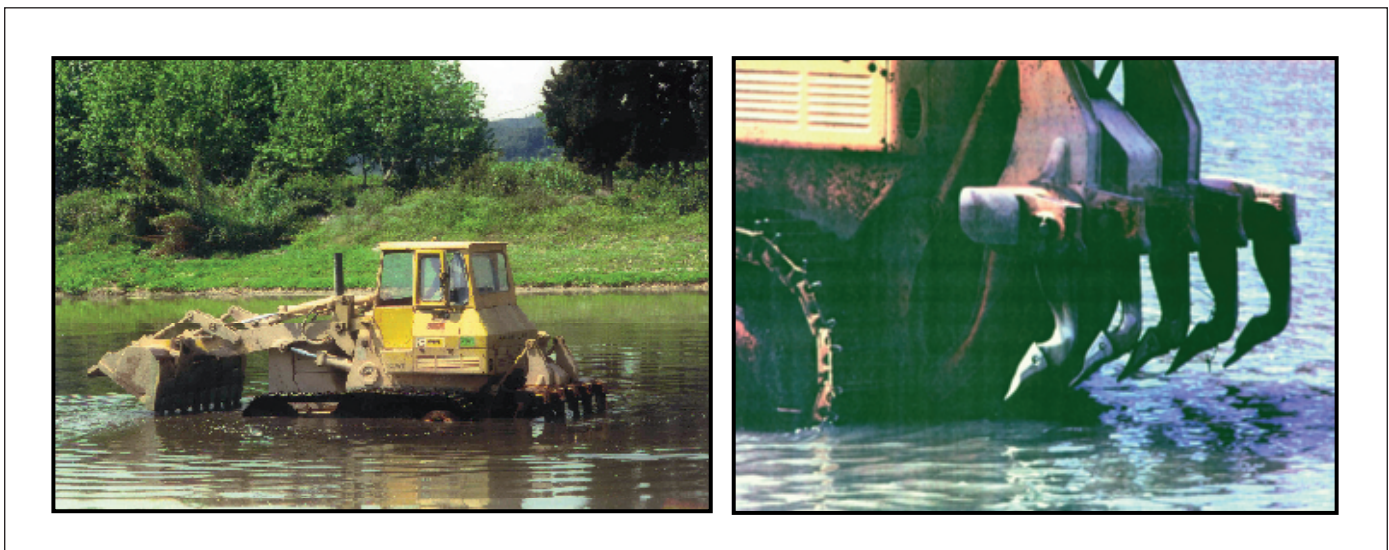
Figura 4. Dispositivos de escarificado del lecho del río Llobregat para el aumento de la recarga al acuífero. El río en este tramo es influente Figure 4. Scarification devices of the Llobregat river bed
