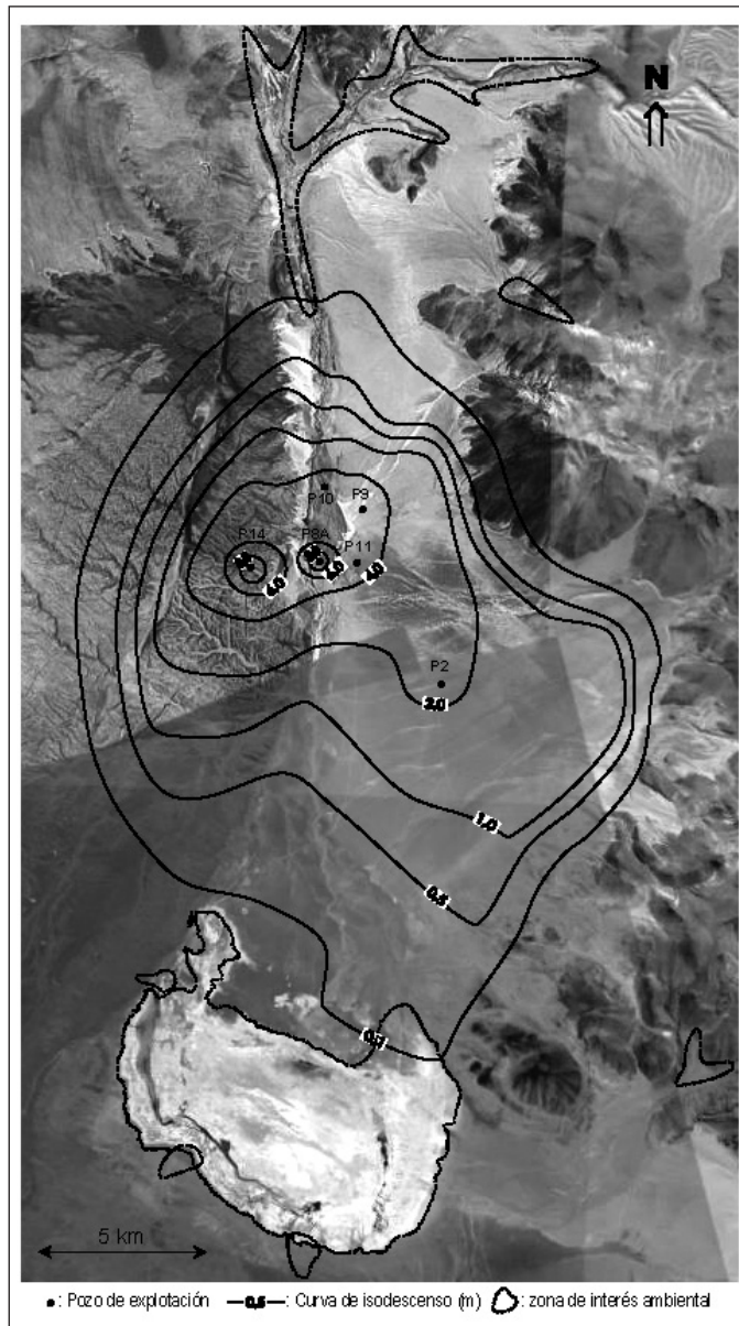
Fig. 13. Descensos esperados en el acuífero medio a los de 25 años de explotación a 200 L/s
