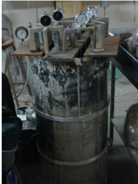
Figura 4.9. Modelo 4. Se colocaron dos escalones en forma secuencial y las mediciones se realizan en una traza perpendicular a la configuración del escalón.
