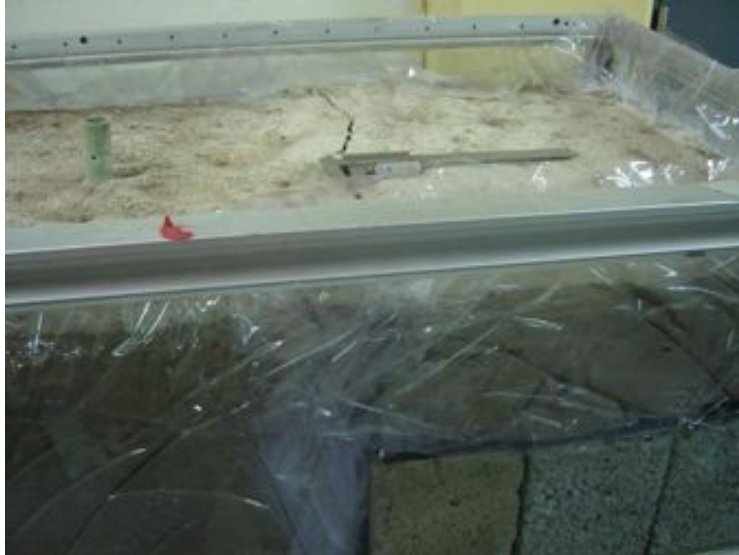
Figura 5.9. Vista del agrietamiento observado al finalizar la prueba del modelo 3, se observaron aberturas de hasta 3 mm únicamente en la zona ubicada sobre el escalón de 14.8 cm de espesor.
