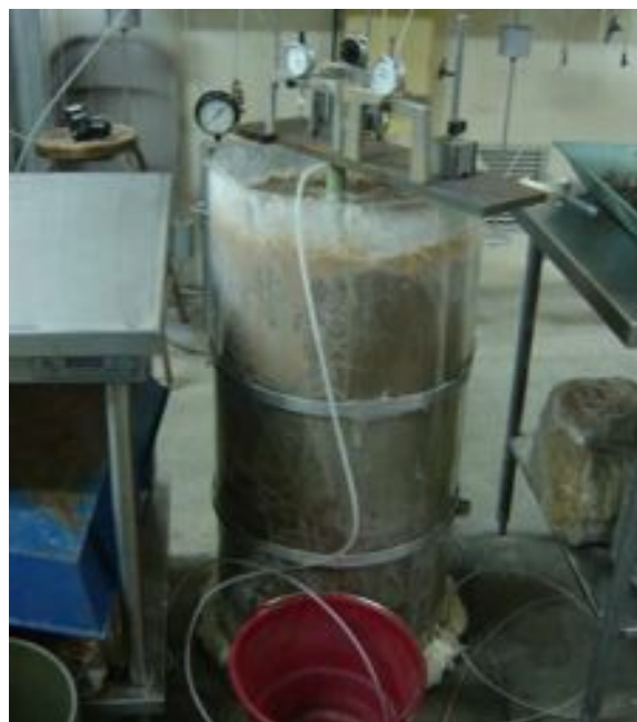
Figura 4.7. Se observa el modelo 2, midiéndose por medio de extensiones en los micrómetros la deformación generada por la extracción de agua.
