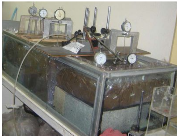
Figura 4.8 Modelo 3. Se colocaron dos escalones simulando el “enrocamiento”, posteriormente se presentan las dimensiones del modelo.
