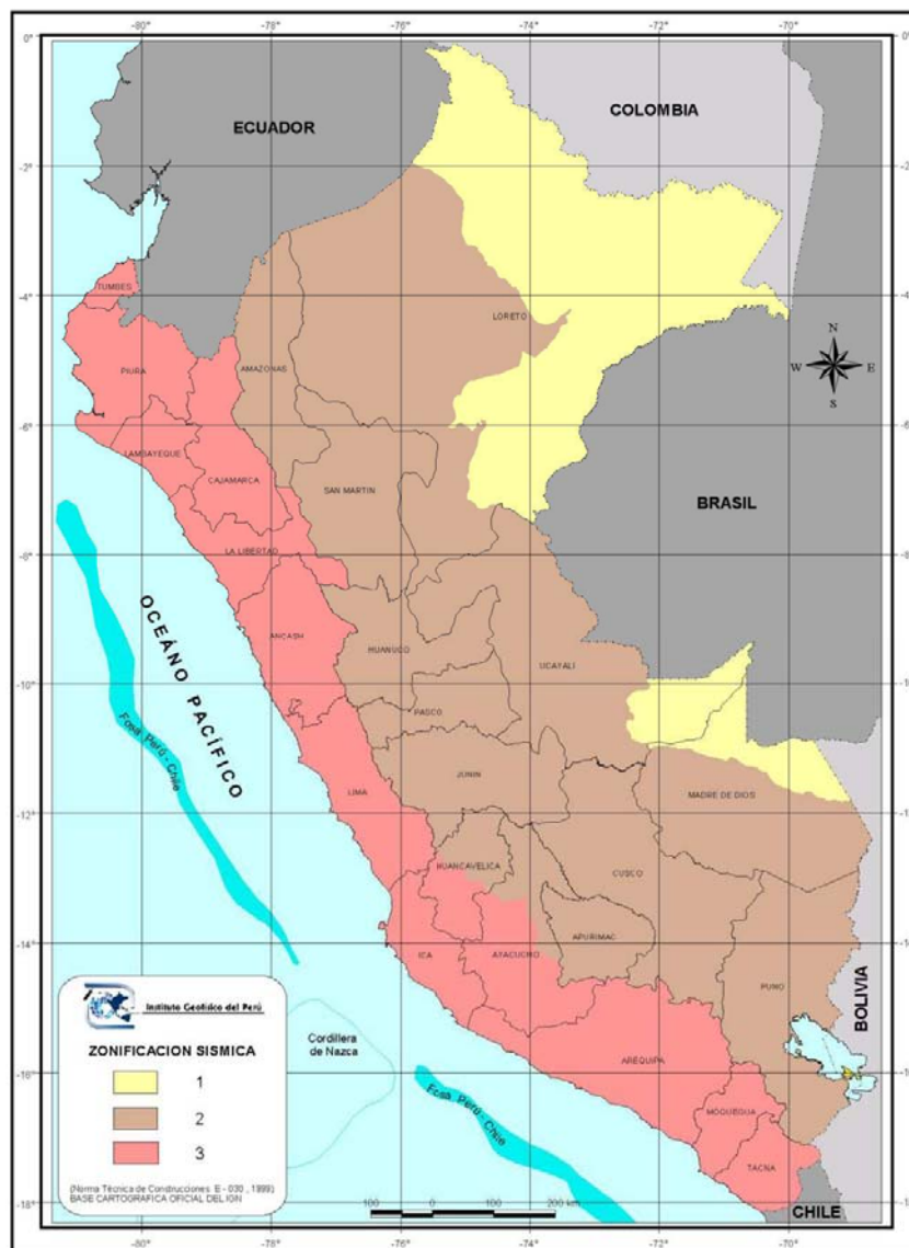
Figura 10. Zonas sísmicas oficiales de Perú (NTE-E.030, 1997). Los Factores de Zona, en unidades de la aceleración de la gravedad terrestre (g), son: Zona 3: 0.4 g, Zona 2: 0.3 g, Zona 1: 0.15 g. “Este factor se interpreta como la aceleración máxima del terreno con una probabilidad de 10% de ser excedida en 50 años” (NTE-E.030, 1997).
