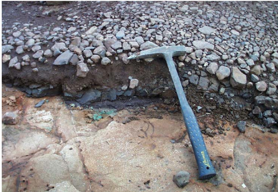
Figura 6. Contacto entre la colada basáltica y las areniscas de la Formación Solari, en cantera de "ripio".
