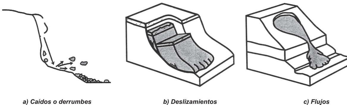
Figura 5.1 Principales tipos de deslizamientos en laderas
