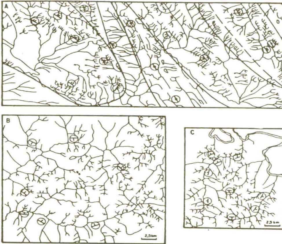
Figura 11- Exemplo de interpretação da estrutura geológica pelas formas da rede de drenagem: A-áreas moderadas e fortemente dobradas, B- baixo estrutural, C- alto estrutural(domo).
